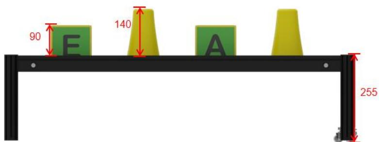
图 4.2-9 可移动资源岛示意图（正视图）
