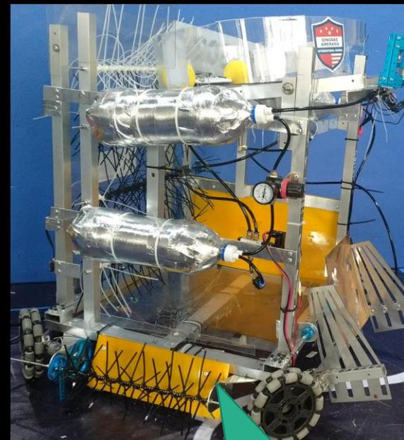
多层传递式送球，气动式抓手。转轮式送球实现高效连射效果。
